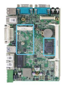
mini-PCle/ SIM slot on MezIO<sup>™</sup> module
